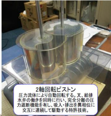
都市型水力発電装置 重力エネルギーが発電をし、水を放流しない都市型水力装置・実証機製作中
