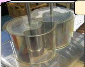
2軸回転! ロータ 圧力流体により自動回転する。又、給排水弁の動きを同時に行い、完全分離の圧力遮断機能を有し、吸入・排出を異相位に交互に連続して駆動する特許技術。
