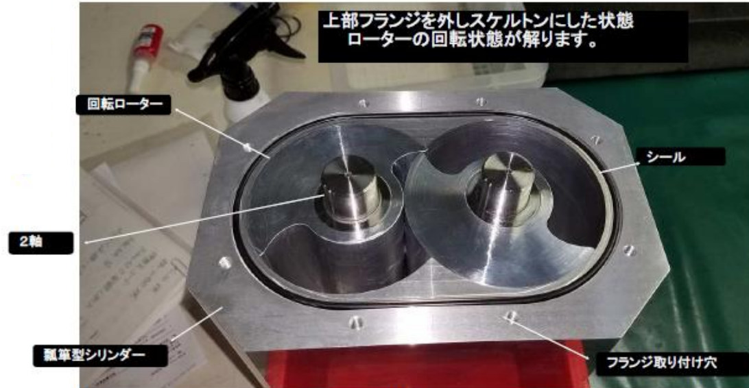
2軸回転ロータ水車の 立体概略透視図
